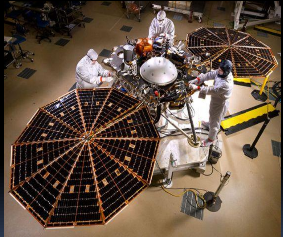
La sonda espacial 'InSight', de la NASA, durante un ensayo de los paneles solares en los talleres de Lockheed-Martin, en Denver (EE.UU.) / NASA/JPL-CALTECH/LOCKHEED-MARTIN
